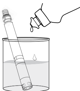
Figura 72 Limpieza del sensor de pH y pH/ORP con jabón para lavar platos
