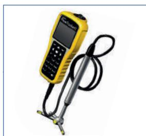
Equipos de Aforo ADV (Correntómetro Acústico Doppler)
